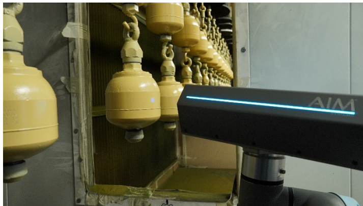
在线对金属压力罐底漆层湿膜测厚
